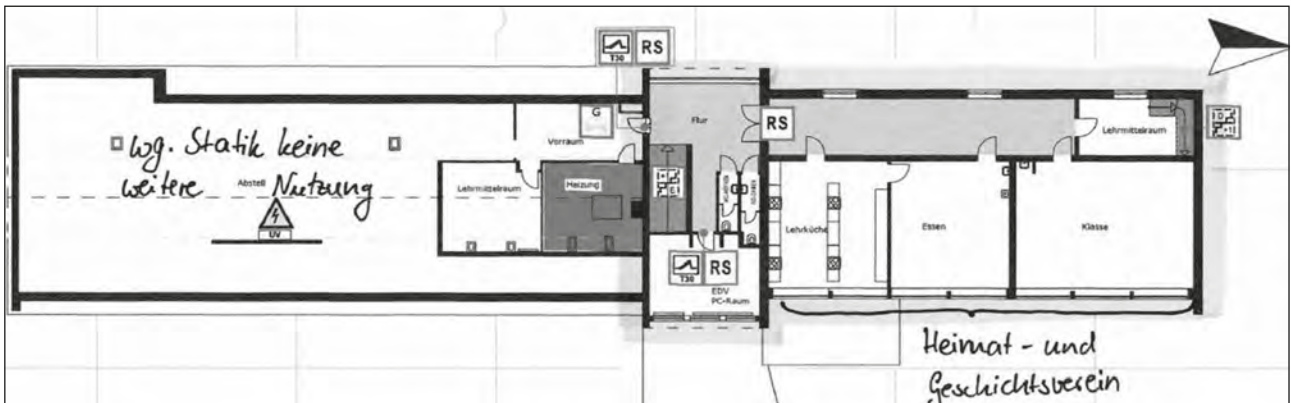
Einschränkung aufgrund der Statik
